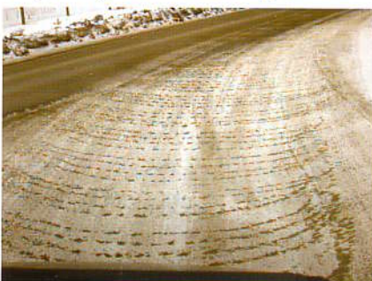
Slik ser et test-felt ut for å måle effekt på veg i form av friksjon tilskudd etter strøing.
